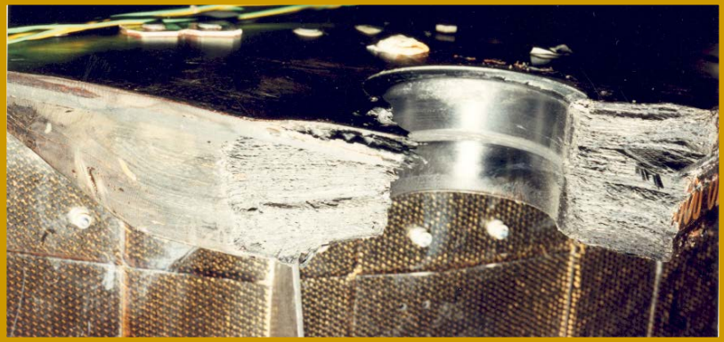
Failed Test Lug
